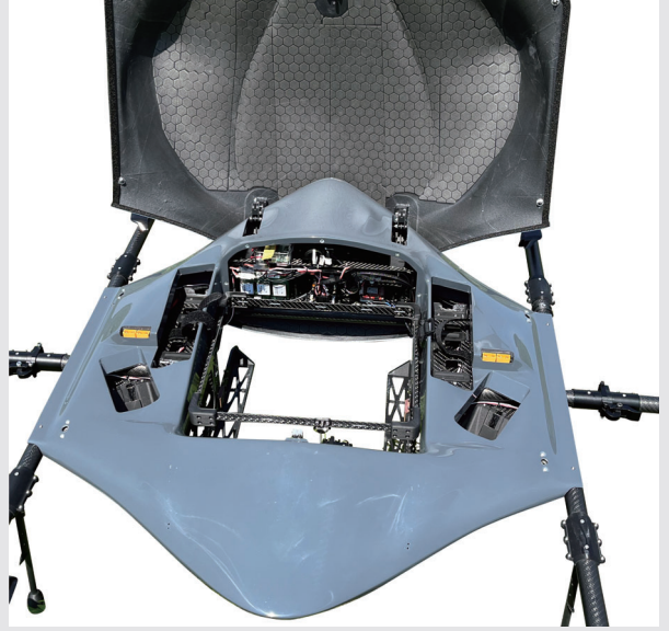
上から簡単に荷物を搭載する方式にすることで ペイロード 5kg までの荷物の着脱が容易に可能
