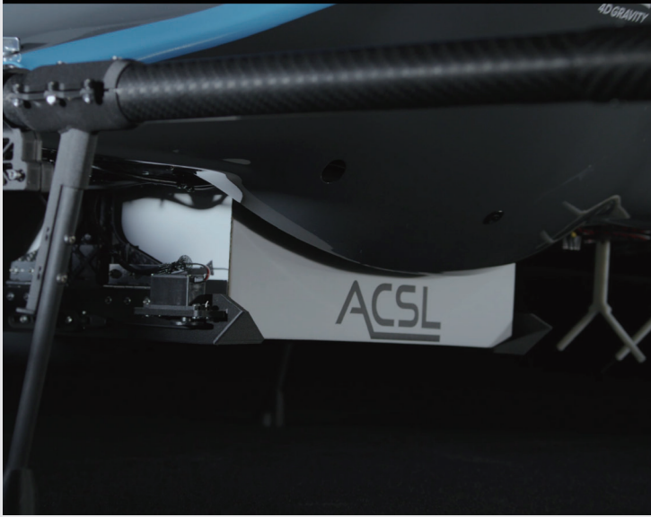
重心制御技術「4D GRAVITY®」により、荷物の揺れを抑えることが可能
