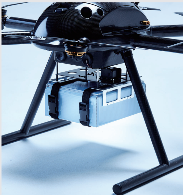
物流機構と輸送箱が標準搭載されており、内容物重量1.5kgの搬送が可能
